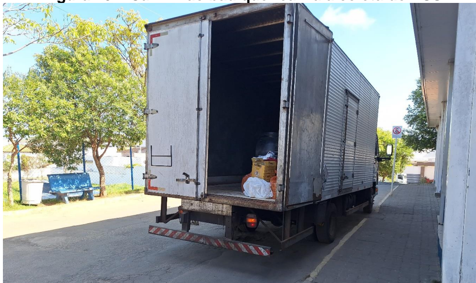
Figura 20 – Caminhão baú que realiza a coleta de RSS
