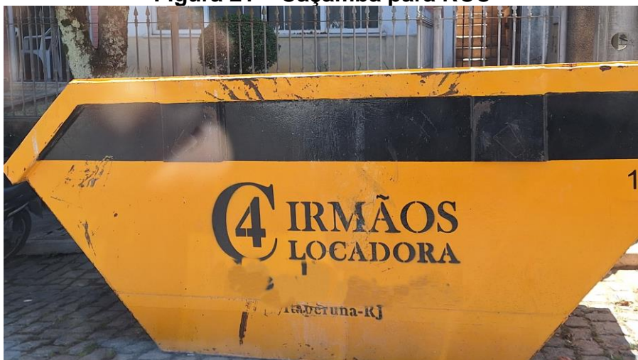
Figura 21 – Caçamba para RCC
