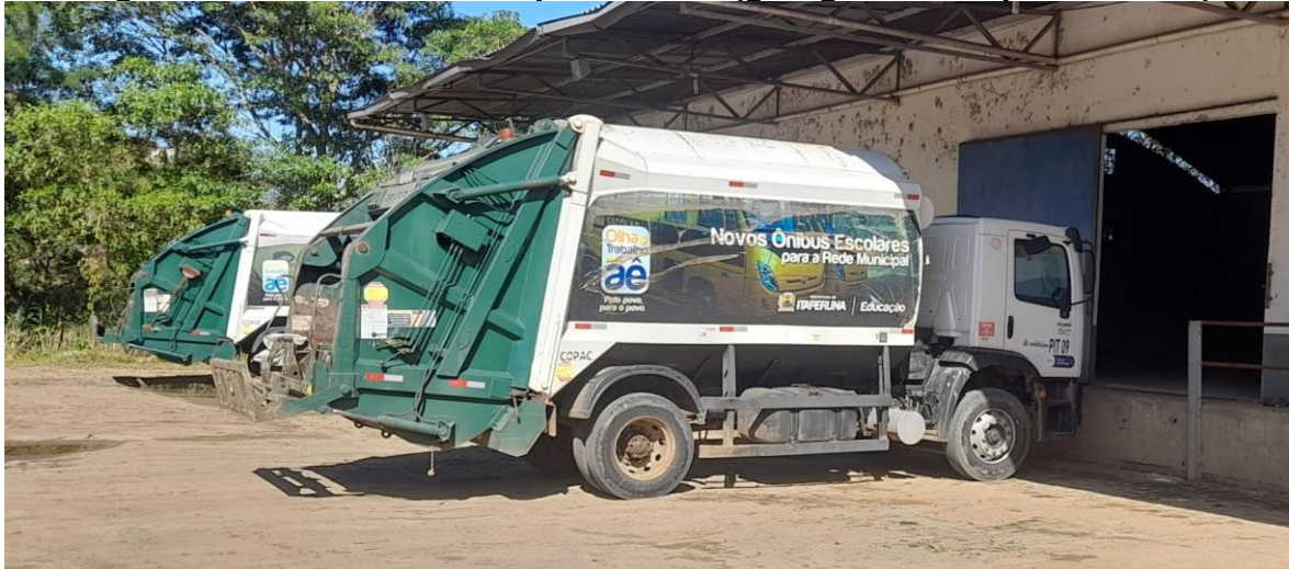
Figura 4 – Caminhões Compactadores (garagem da empresa Plural)
